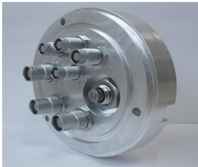
Figure 2.2.4 Bride en acier équipée de passages électriques de l'intérieur du MEB à l'extérieur. Son épaisseur permet d'arrêter les rayonnements X issus de l'intérieur de la chambre d'observation.
