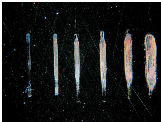
FIG. 2.8 – Photographie de la surface de l'échantillon comprenant les six traces d'usure (contact lubrifié par du dodécane seul).
