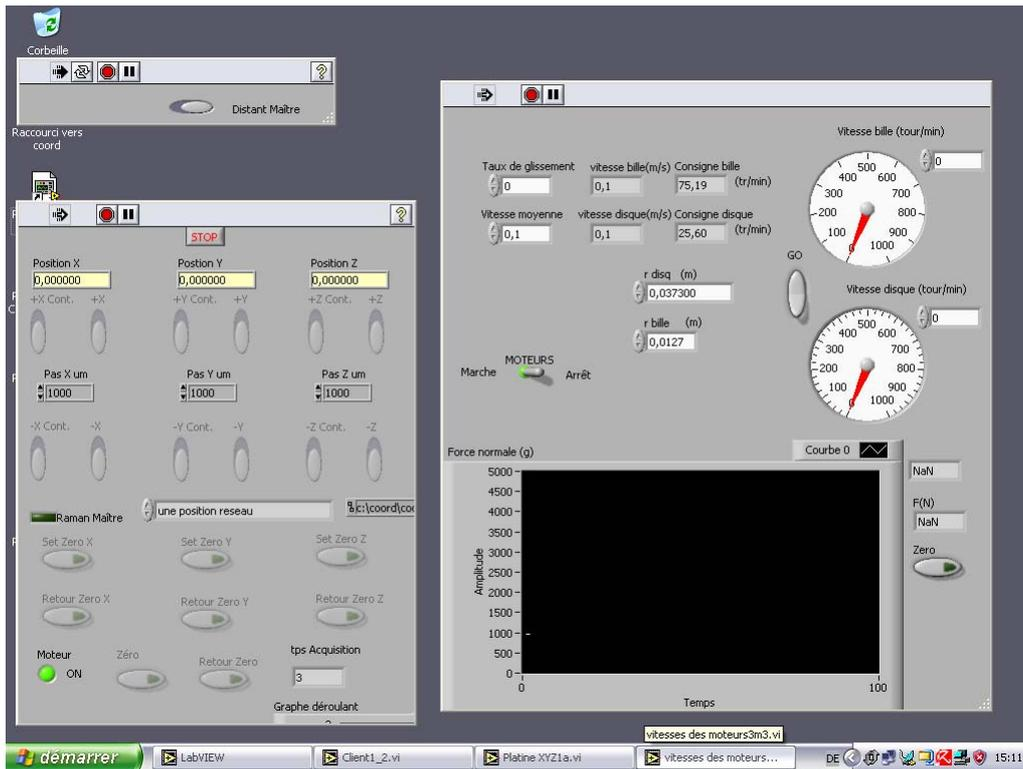
Figure A.IV.1 : Programme principal de pilotage de la machine EHD
